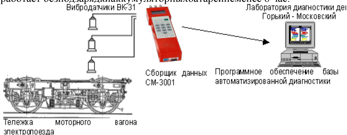
Рис.2. Общий вид вибро диагностического комплекса депо.
