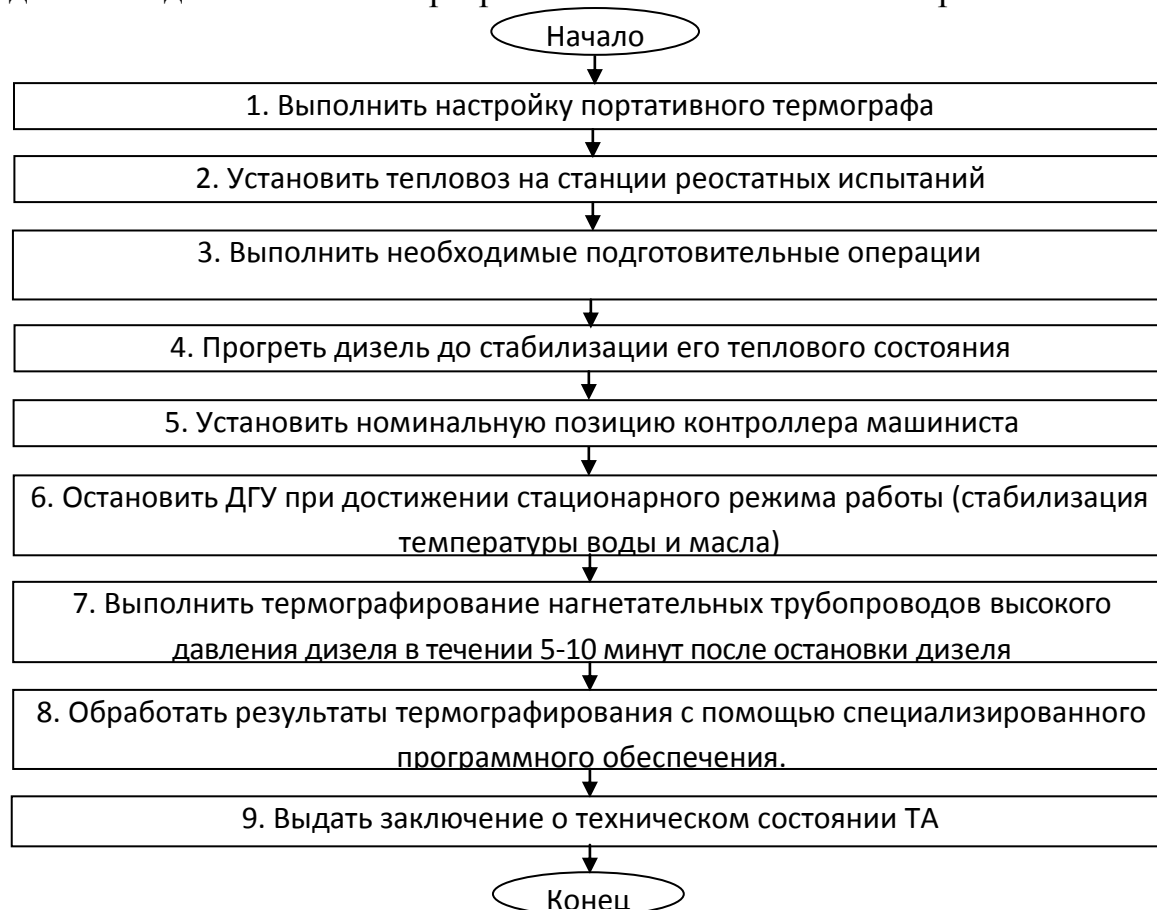
Рис. 1. Алгоритм технологии тепловизионного контроля технического состояния топливной аппаратуры тепловозных дизелей
