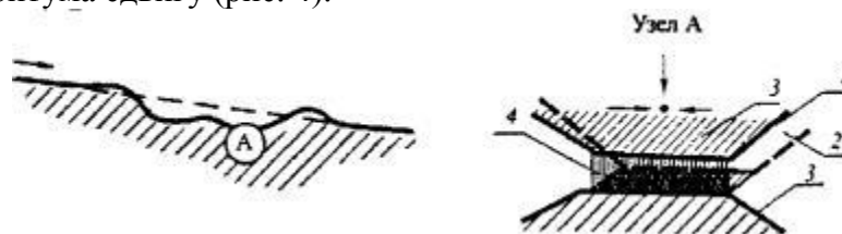
Рис. 4. Колея, образующаяся в результате вязкопластического размягчения вяжущего: 1 - первоначальное положение щебёнки; 2 - положение щебёнки после смещения; 3 - щебёнка; 4 - плёнка вяжущего.
