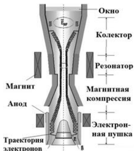
Рис. 1. Схема технологического 28ГГц 15кВт гиротрона
