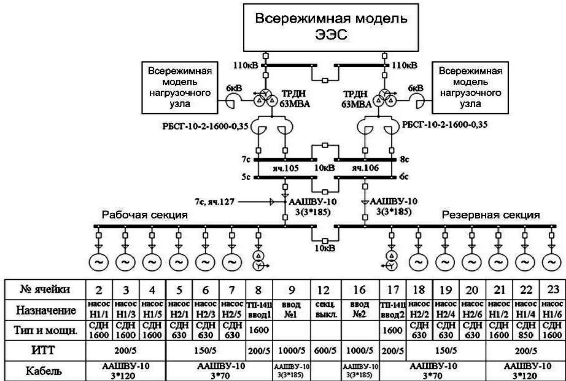
Рис. 1. Однолинейное изображение схемы электроснабжения синхронных двигателей
