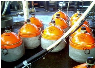
Рис.1 - Автономная донная сейсмостанция АДСС [4].
