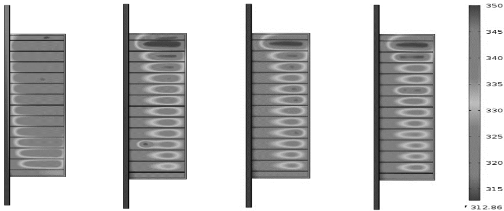
Рис.5. Температурное поле цилиндра с 13 пластинами через 12 часов для различных входных скоростей.
