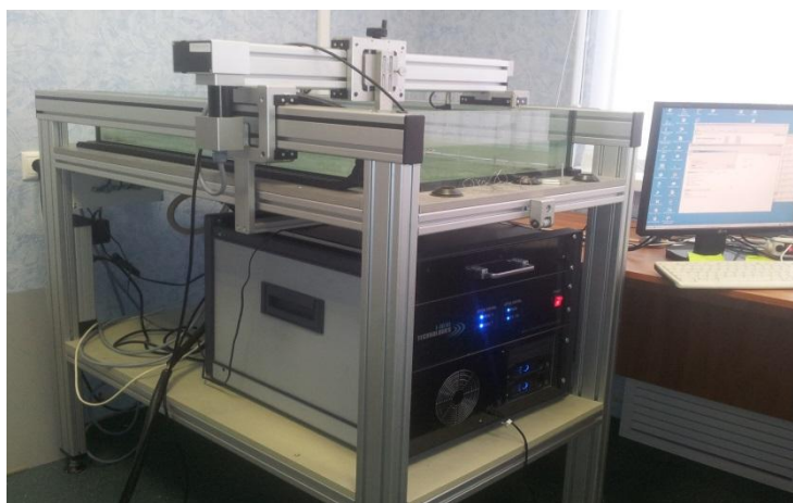
Рис. 2. Стационарной системы ультразвукового контроля IDEalSystem3D.
