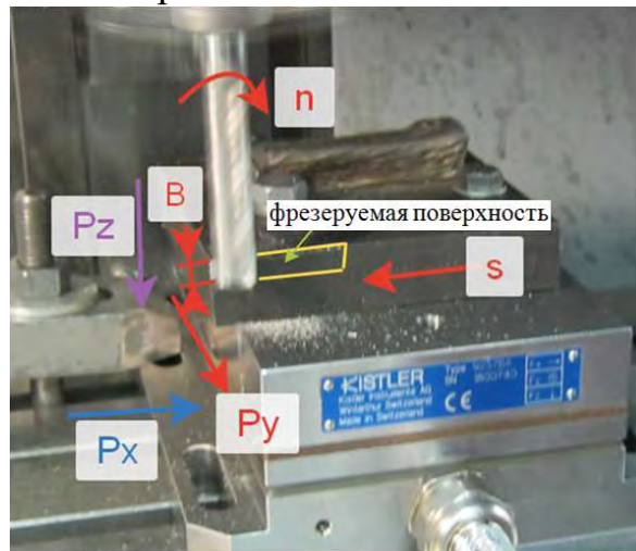
Рис. 1. Положение заготовки относительно фрезы и направление подачи s ( s_m , мм/мин) при встречном фрезеровании подложки концевой фрезой
