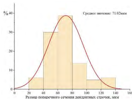
Рис. 3. Микроструктура и гистограмма распределения размеров поперечного сечения дендритных строчек в нижней части образца
