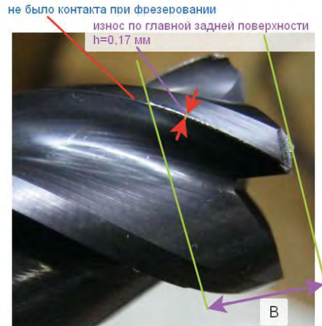
Рис. 1. Износ фрезы по задней поверхности примыкающей к главной режущей кромке и по уголкам.
