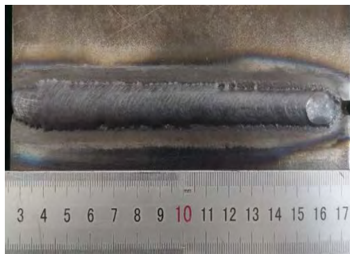
Рис. 3. Морфология формирования второго сварного шва
