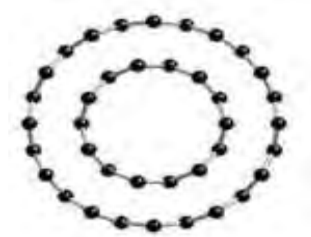
Рис.4. Виды вдоль оси трубы окончательной конструкции (DWCNT)
