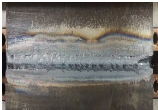
Рис. 2. Морфология формирования начального шва сварки
