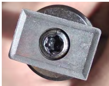
Рис. 2. Сменная многогранная пластина ZDCT 150308 до полировки
