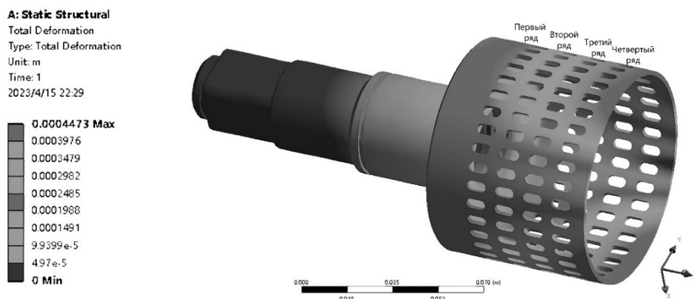
Рис. 3. Деформация сепаратора от расчетной нагрузки на валу 800 Н·м
