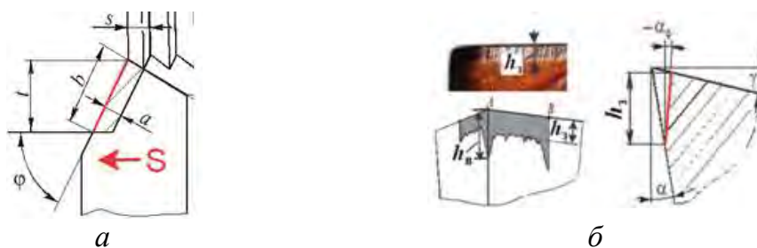
Рис. 1. Контакт главной режущей кромки с заготовкой по всей её длине в начале резания (а) и фаска износа по задней поверхности длиной h_3 и с задним углом на ней \alpha_f = 0 \dots -3^\circ (б)
