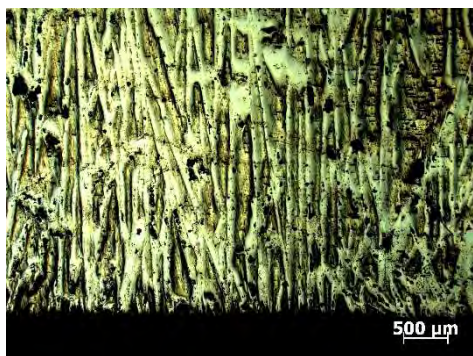
Рис. 3. Микроструктура и гистограмма распределения размеров поперечного сечения дендритных строчек в нижней части образца
