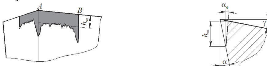
Рис. 1. Износ резца по задней поверхности
