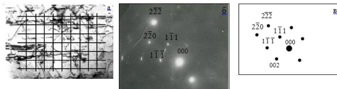
Рис. 2. Пример для определения средней скалярной плотности дислокаций в ГЦК сплаве после деформации \epsilon_{ист} = 0,05 :
