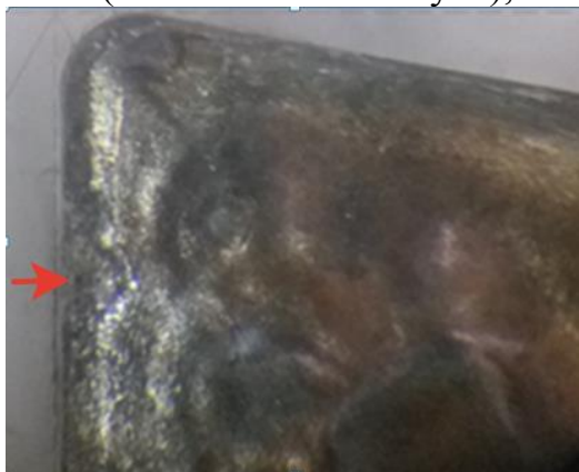
Рис. 4. Локальный износ режущей кромки (ус). v=180 м/мин, t = 1 мм, s = 0,13 мм/об h_z=0,31 мм
