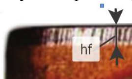
Рис. 3. Износ зуба фрезы по задней поверхности
