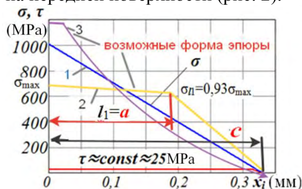
Рис. 2. Возможные формы эпюры нормальных контактных напряжений \sigma на передней поверхности реза. ВТЗ-1 – ВК6, толщина среза a = 0,11 мм, скорость резания v = 60 м/мин, передний угол \gamma = 0^\circ
