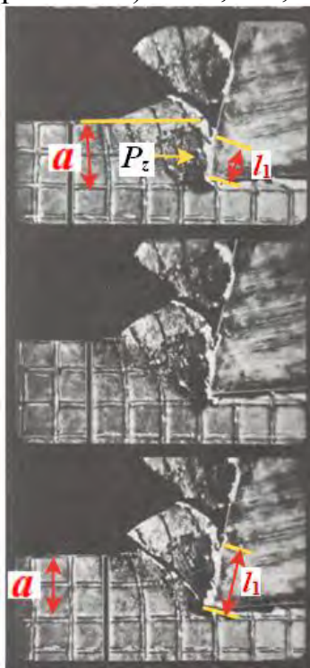
Рис. 3. Изменение длины контакта элемента стружки с передней поверхностью реза в процессе формирования элемента стружки
