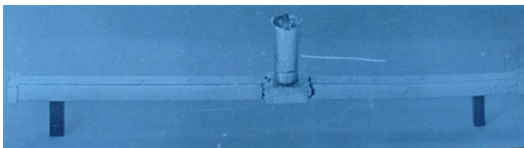
Рис. 2. Горячая трещина в отливке
